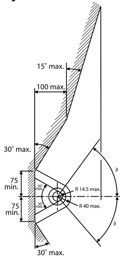
**PL** Należy zagwarantować przestrzeń swobodną według załącznika VII, rysunek 25a/b Regulaminu EKG ONZ 55.02 przy dopuszczalnym ciężarze całkowitym pojazdu.
